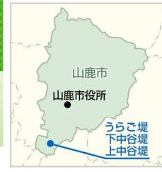
このマップは、晴天時の地震により、ため池が決壊した場合に、どのような被害となるかを知るために、うらご堤・下中谷堤・上中谷堤が同時に決壊し、全ての貯水量が瞬時に流出する状況を想定しています。
