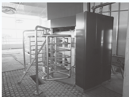
平成27年度農業担い手支援総合対策事業で導入した「ロボット搾乳機」
