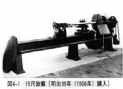
図4-1 15尺旋盤【明治39年（1906年）購入】 製造会社（セリッグソン・ネルター社）米国 仕様（床長：4,572mm） （幅：700mm） 国内の工作機械メーカーがようやく製造を見た時代に、既に本学では大量の本旋盤が設置されていたことは驚くべきことである。昭和47年頃まで長大物加工並びに正面旋盤の代用として活躍された。
