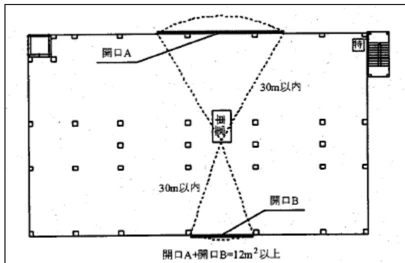
《車室の各部分から水平距離30m以内の外周部の12m<sup>2</sup>以上の有効開口部の例》
