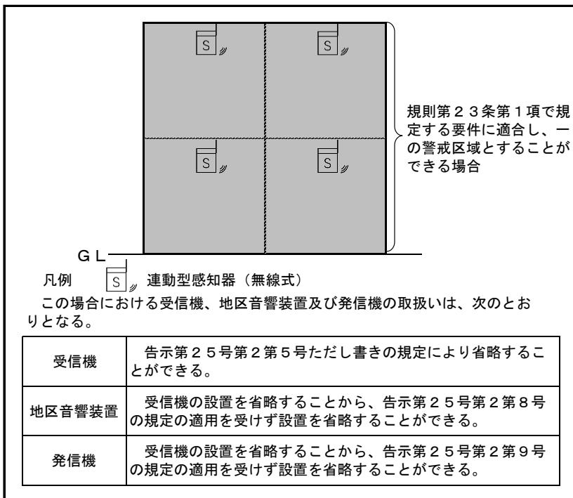
(5) 特定小規模施設に該当する小規模特定用途複合防火対象物に設ける特定小規模施設用自動火災報知設備の構成は、次の例によること。
