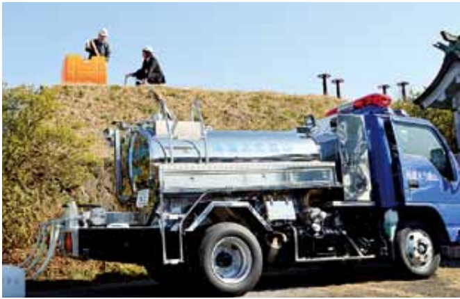
配備された加圧ポンプ式給水車
