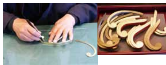
⑧蕨手切り、足切り、弓切り、手びれ切り、足びれ切り 「型紙毛がき」した灯籠紙を重ねてずれないように小刀で切り離し部位の統一性を図る
