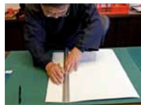
③蛸貝ひき 「歩つき」した灯籠紙の点と点の間を蛸貝（金属製ヘラ）で筋目を付ける
