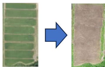
複数の小区画ほ場を1つにまとめ（合筆）、 ロボットトラクタの作業効率を向上
