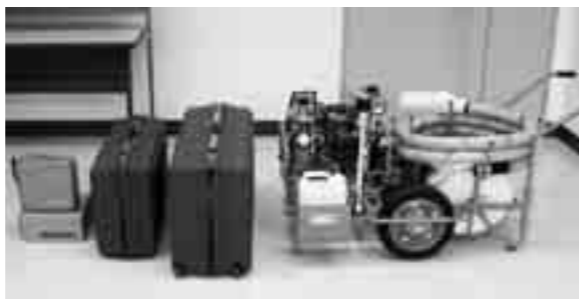
▲配備された軽可搬消防ポンプと救急蘇生訓練資機材一式
