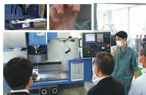
マシニングセンターでアクリル板を加工する様子を説明する青木さん
